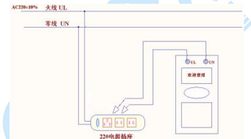
图 8 分机现场接线示意图
